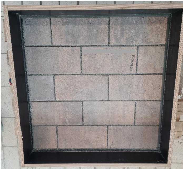
Abbildung 1: Prüffläche mit Fugenverfüllung
