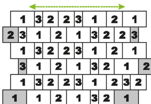
Um keine durchgängigen Längsfugen zu erhalten, sind in den Zeilen 2, 4 und 6 jeweils die äußeren Steintypen zu tauschen.
